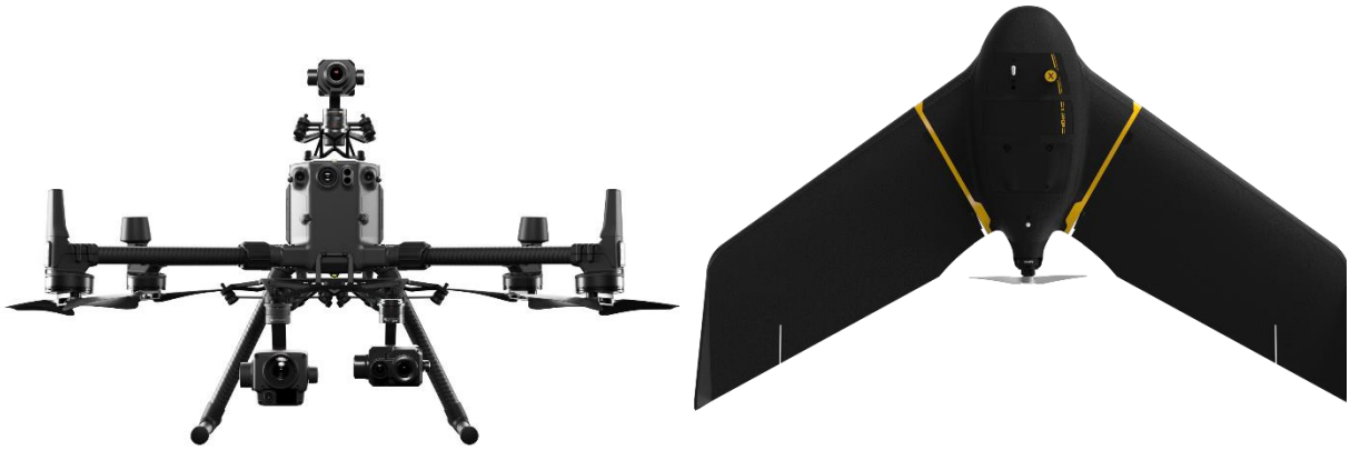
Նկ. 2 Աերիալ պլատֆորմների օրինակներ, ձախից՝ DJI Matrice 300 RTK պտուտակավոր ԱԹՍ, աջից SenseFly eBee X ֆիքսված թևերով ԱԹՍ
